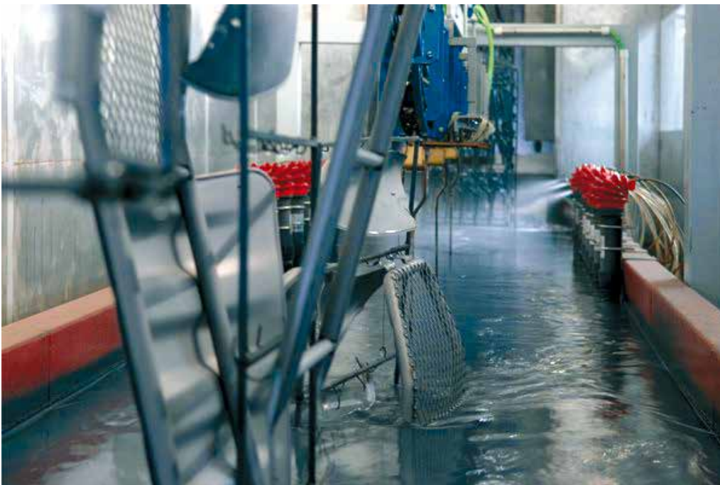
7 - Detalle del tanque de cataforesis.
